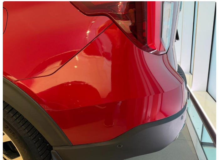
1.2 Liten ripe støtfangerhjørne venstre bak.
