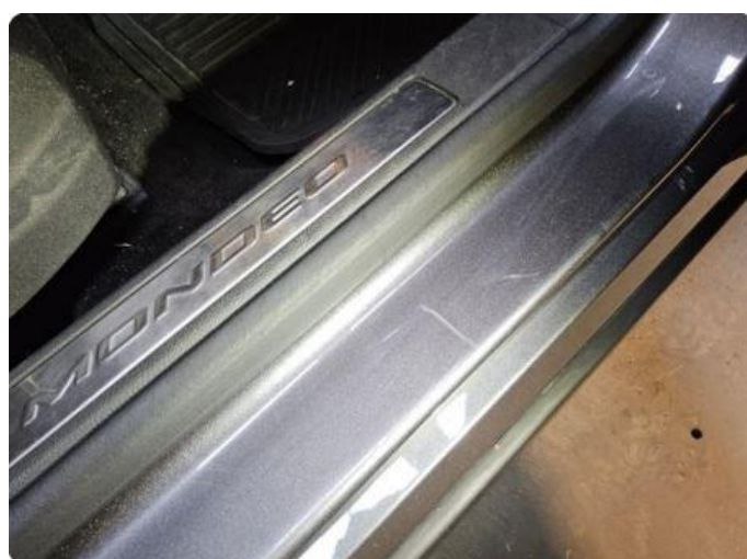
2.5 Noen riper og småbulker døråpninger.
