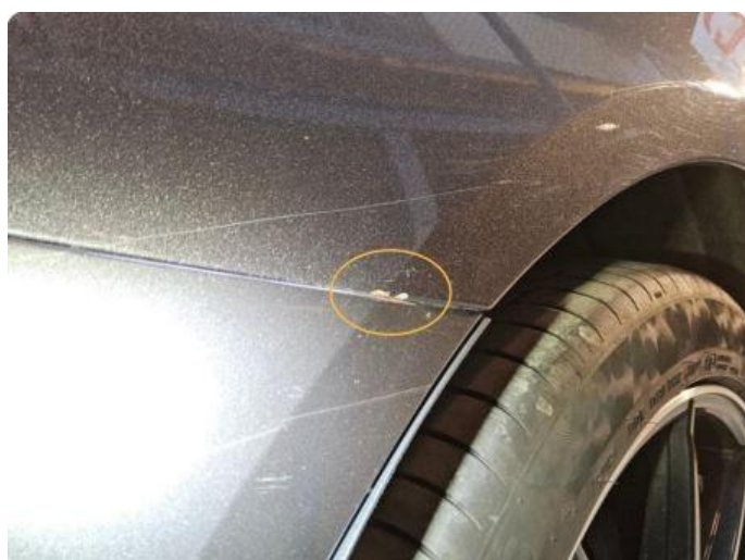
2.2 Korrosjon mot støtfanger bak. Skjerm høyre bak.
