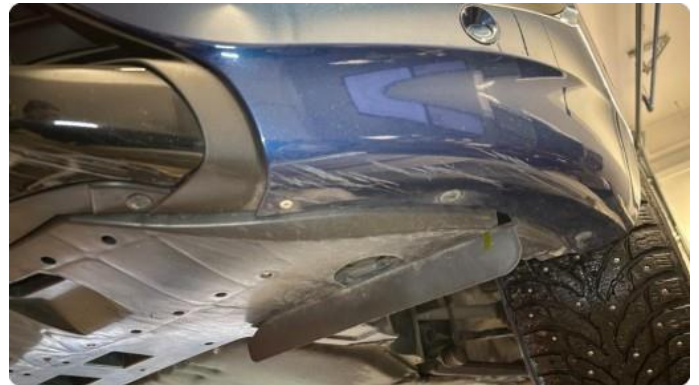
1.2 Riper underside støtfangerhjørne venstre foran.
