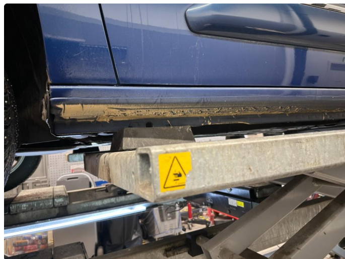
1.6 Matt/slitt lakk underside kanaler begge sider.
