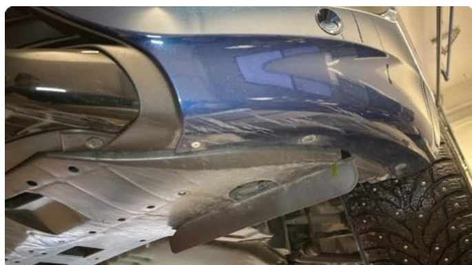
1.4 Riper underside støtfangerhjørne venstre foran.
