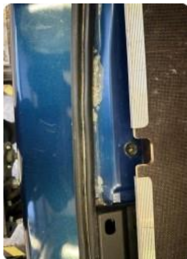
1.2 Lakk flasser døråpning bakluke.
