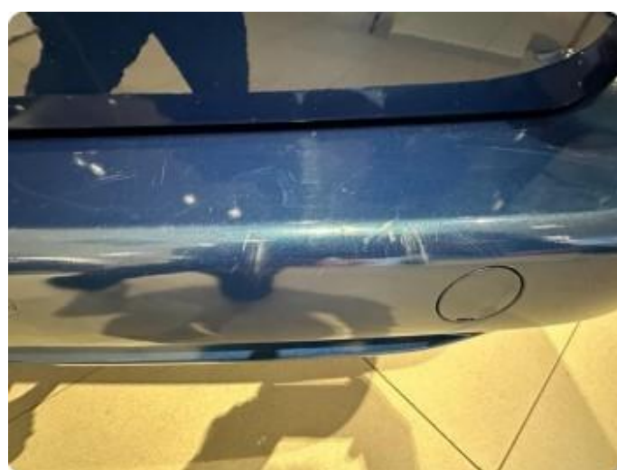
1.5 Riper støtfanger bak. Matt framkant begge sider.
