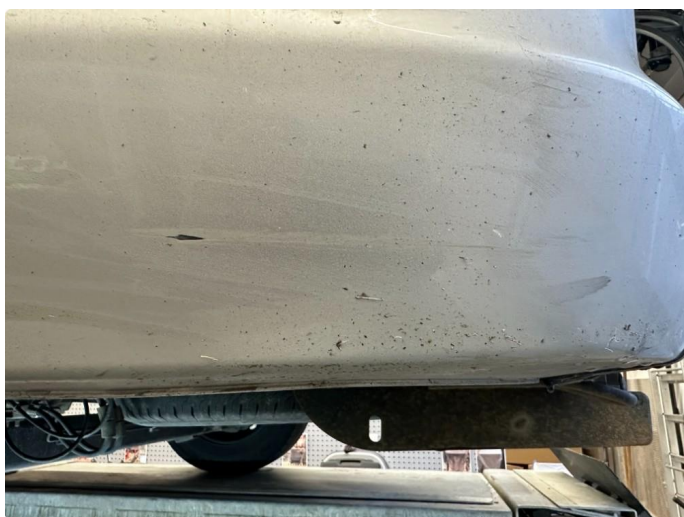
1.4 Riper støtfangerhjørne venstre bak,.
