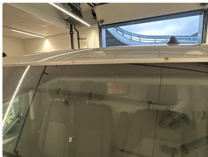
1.5 Steinsprut framkant tak.
