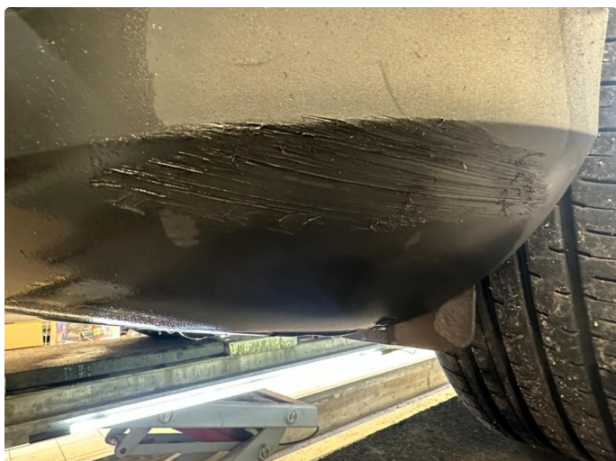
1.2 Riper støtfangerhjørne venstre foran.
