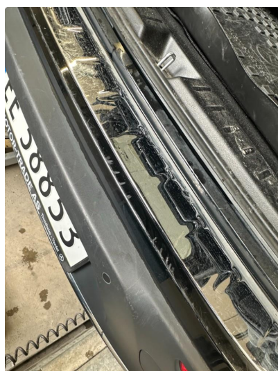
1.3 Riper øvre del støtfanger bak.
