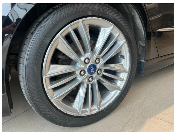
1.6 Slitte sommerdekk. 3 og 4mm. Kromlakk flasser av felger.
