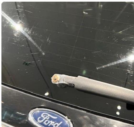
1.8 Mangler deksel pusserarm bak.
