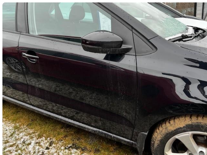
1.2 Bulk framkant dør høyre foran.
