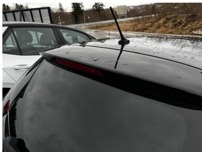
1.3 Riper og en bulk over bremselykt. Lakkbobler over håndtak bakluke.
