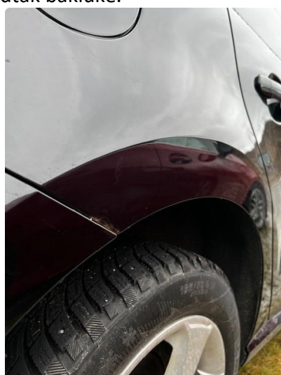
1.4 Korrosjon hjulbue høyre bak.
