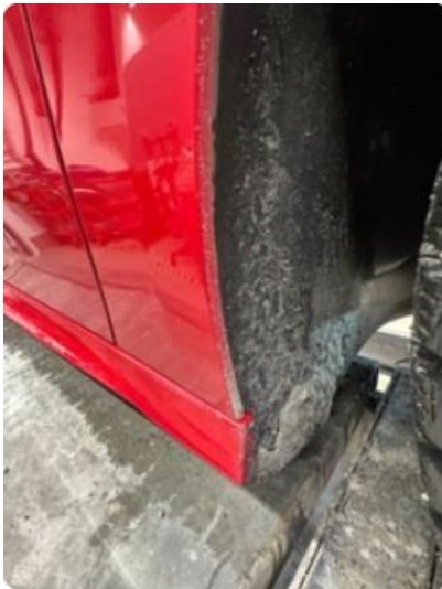
1.3 Steinsprutslitasje hjulbuer begge sider foran.
