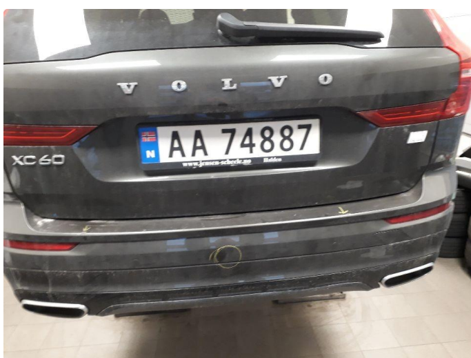
1.3 Ripe(r) ned til grunning
