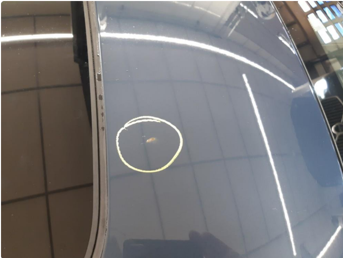
1.2 Steinsprut med rust
