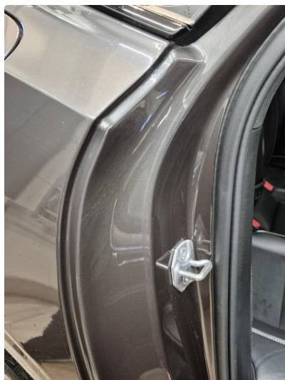
1.1 Ripe(r) ned til grunning
