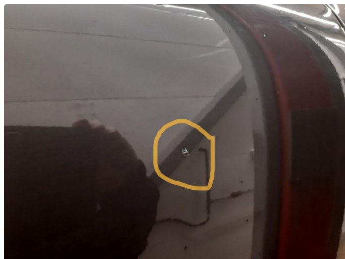
1.3 Ripe ned til grunning
