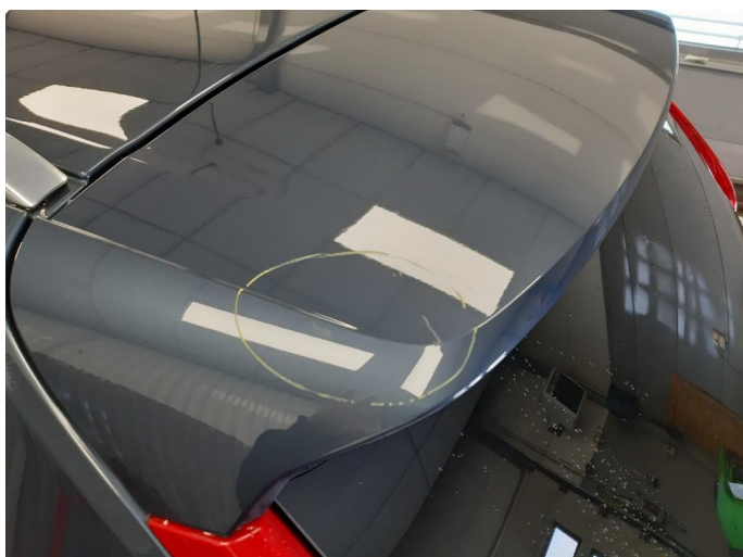
1.4 Ripe(r) ned til grunning
