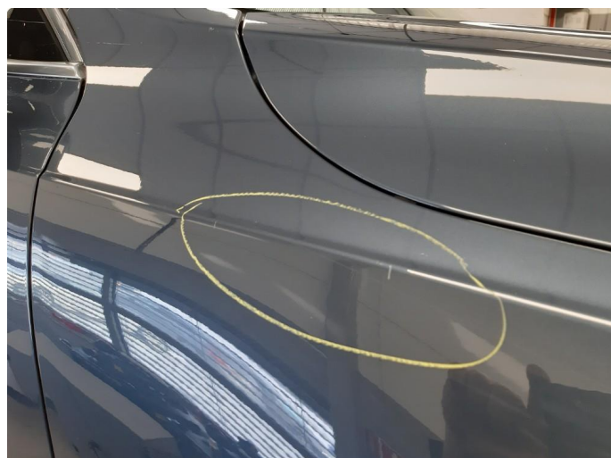
1.5 Ripe(r) ned til grunning
