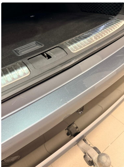
1.3 Noe slitasje ved innlast bakfanger
