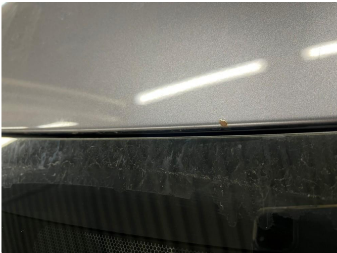
1.3 Steinsprut med rust
