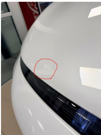
1.1 Hakk/Steinsprut i panser.
