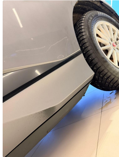
1.2 Slitasje lakk i plast bunn venstre bakdør
