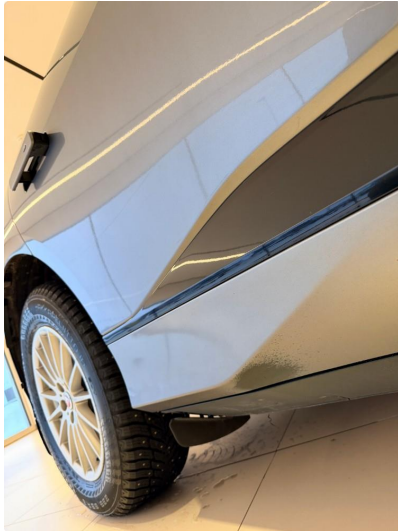
1.1 Slitasje lakk i plast bunn høyre bakdør
