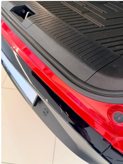
1.9 Slitasje i gjennomsiktig beskyttelse folie bakfanger
