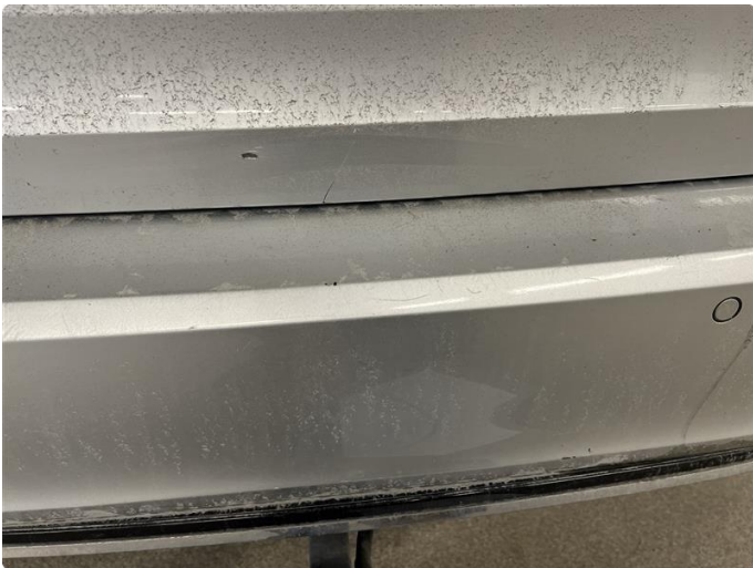
1.2 Lakkskade bakluke. normalt med tanke på alder/Kilometerstand
