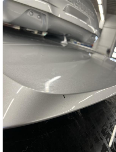
1.2 Lakkskade bakluke. normalt med tanke på alder/Kilometerstand
