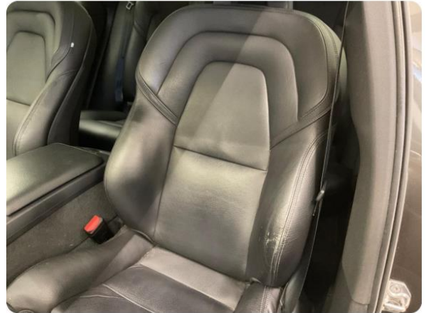
4.1 Øvrige feil Noe slitasje på rygg til førersete 2.1 Noe slitasje i førersete sidestøtte.
