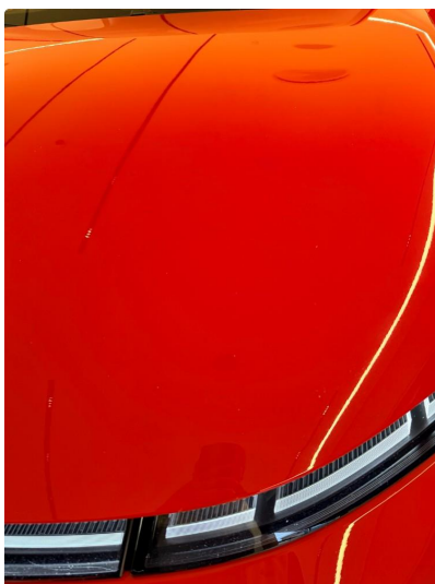
1.3 Små steinsprut panser 2
