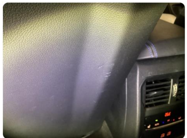
2.1 Skade på seterygg 2.3 Merke i seterygg
