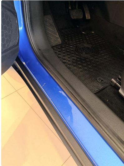
1.1 Noe slitasje i innsteg
