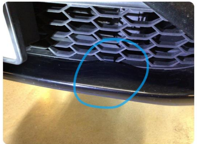
1.4 Ute av posisjon foran nedre ved grill
