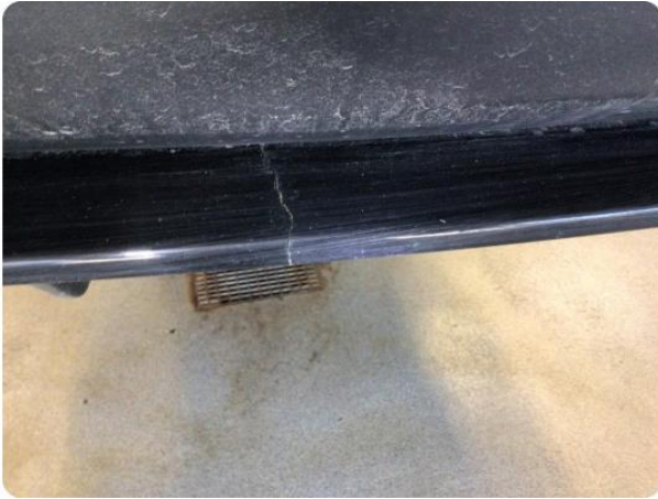
1.2 Øvrige feil Sprekk diffusor bakfanger+skade plastikk
