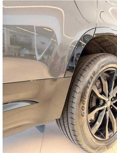
1.2 Noe slitasje fremkant bakhjul venstre side
