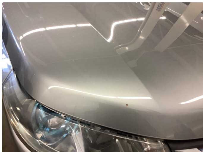
2.1 Noe steinsprut med rust
