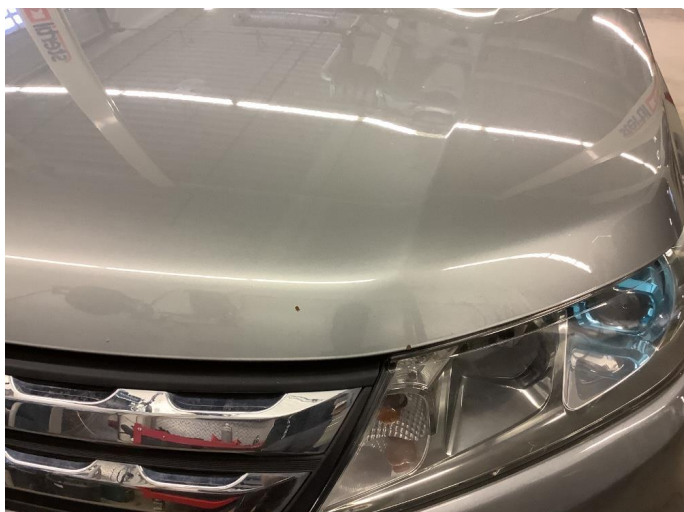
2.1 Noe steinsprut med rust
