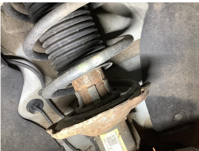
2.1 Rust i nedre fjærbenfeste
