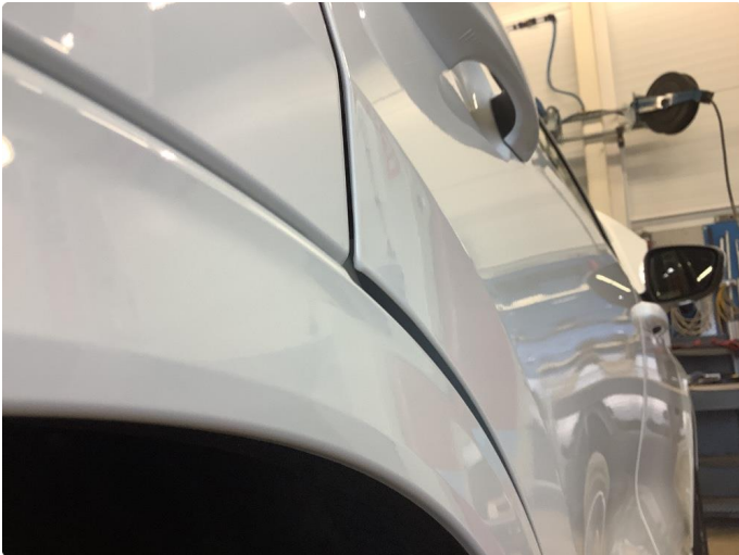
1.1 Liten bulk, uten lakkskade
