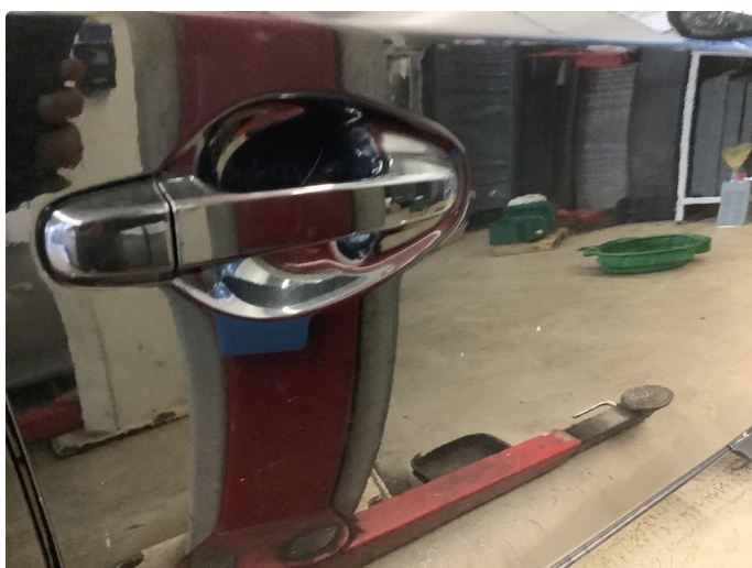
1.2 Liten bulk nede på førerdør.
