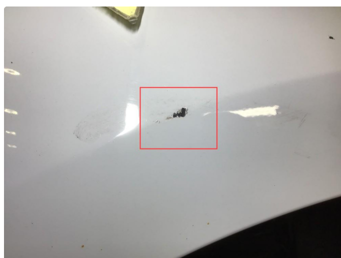
1.2 Lakksår / steinsprut h-framskjerm ( Poleres / Flekkes
