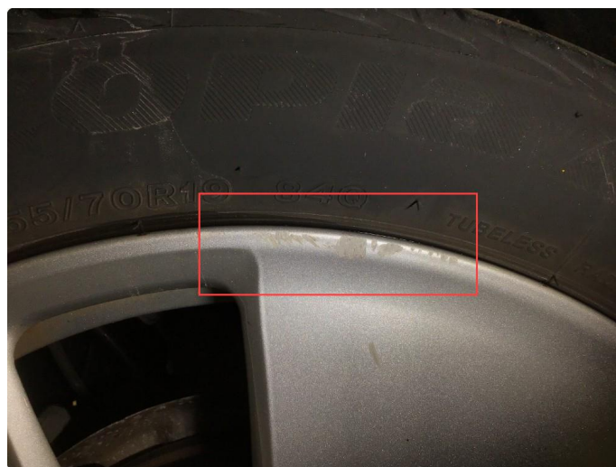
1.3 Noe sår sommerfelg v-bak ( Normal bruksslitasje )
