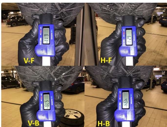
1.5 Mønsterdybde vinterdekk målt ved takst 21.10.2024, 35.201km. Nye dekk påsatt etter takst.
