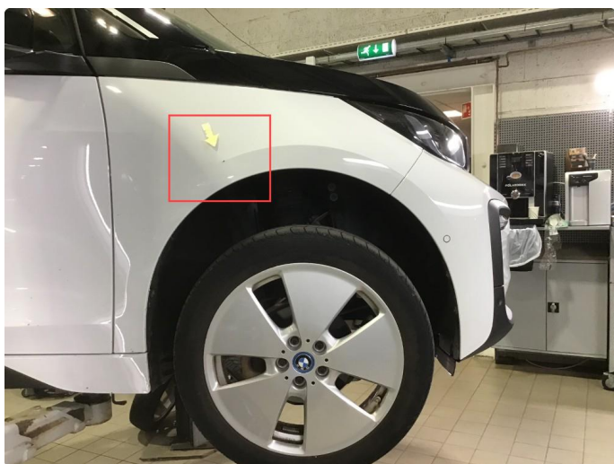
1.2 Lakksår / steinsprut h-framskjerm ( Poleres / Flekkes )
