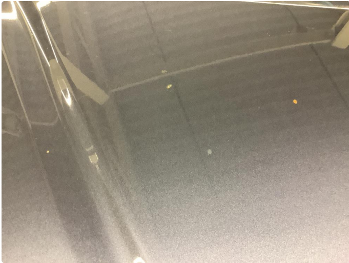
1.1 Noe steinsprut med rust
