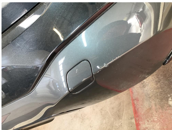
1.1 Noen riper og småbulker
