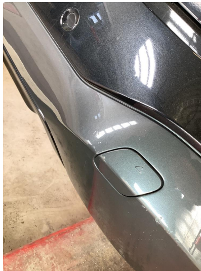
1.1 Noen riper og småbulker
