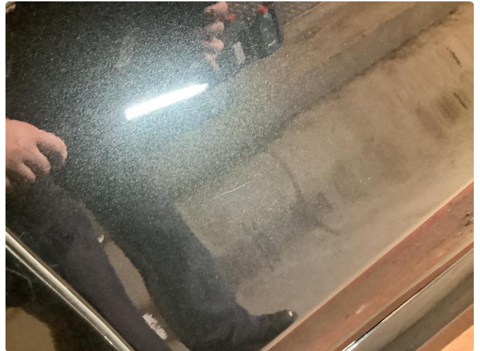
1.1 Noen riper og småbulker
