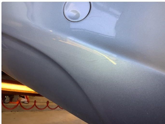
1.1 Noen riper og småbulker
