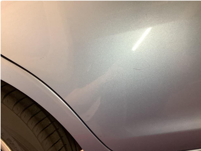
1.1 Noen riper og småbulker
