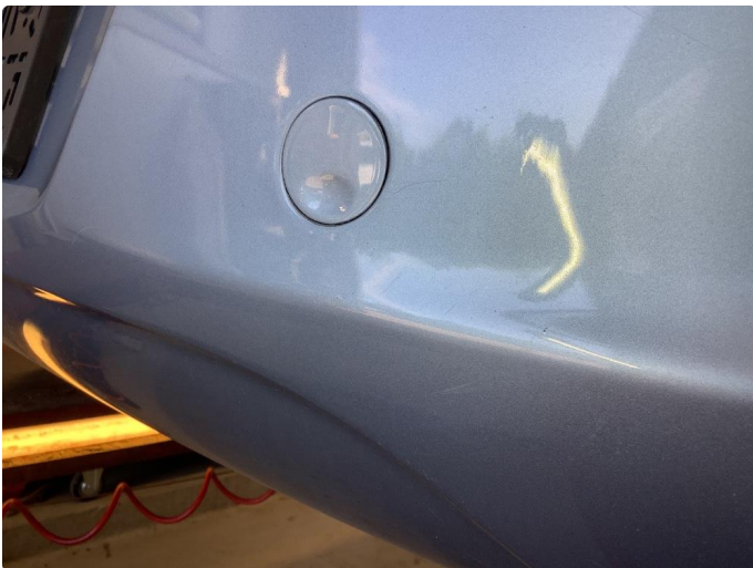
1.1 Noen riper og småbulker
