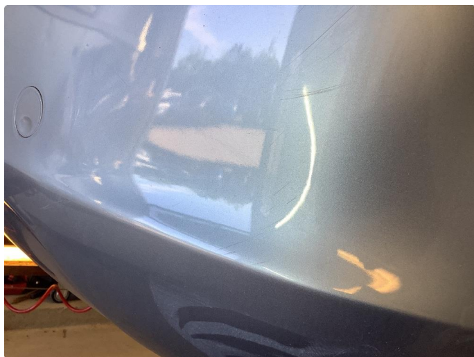
1.1 Noen riper og småbulker
