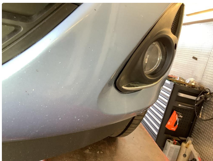
1.1 Noen riper og småbulker
