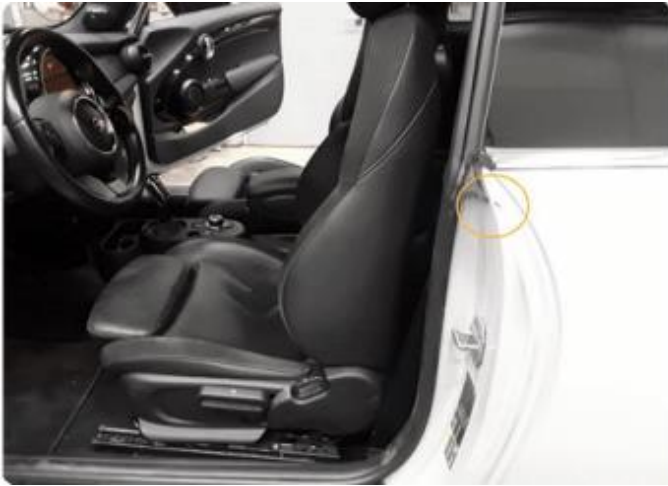
1.1 Påbegynt rust i døråpning.
