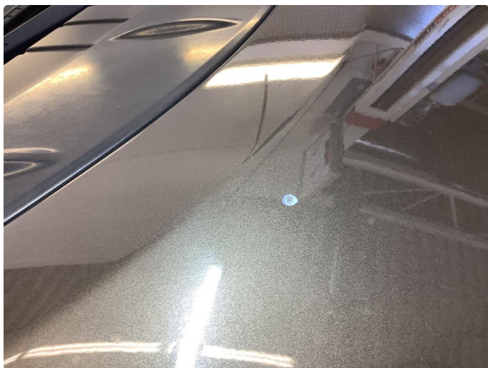
1.1 Noen riper og småbulker
