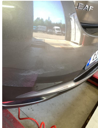
1.1 Noen riper og småbulker
