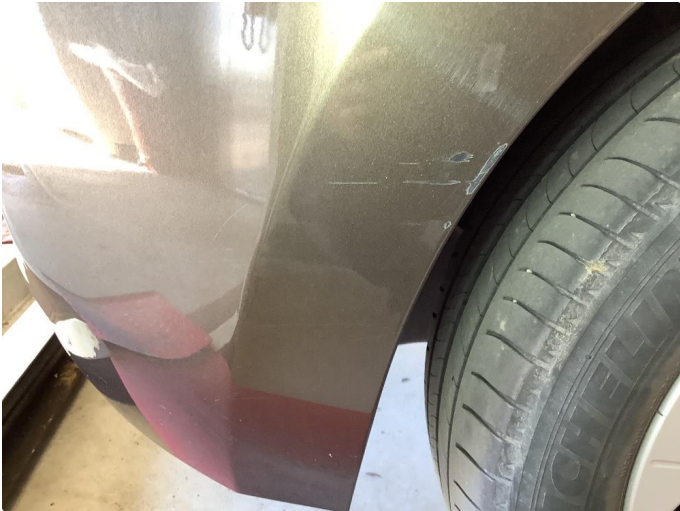
1.1 Noen riper og småbulker
