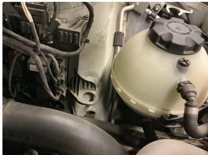
2.1 Kjøleveske under minimum
