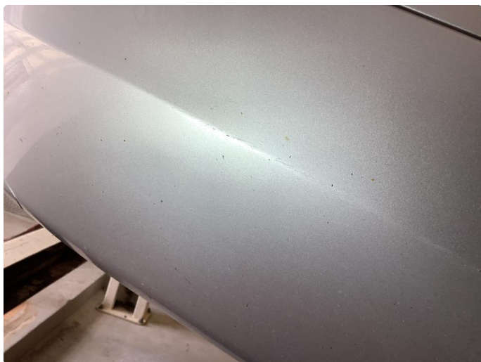
1.1 Noen riper og småbulker
