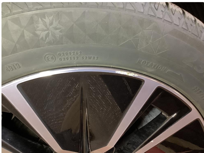
1.1 Noen riper og småbulker
