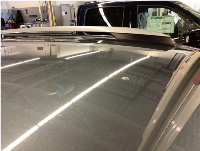
1.1 Steinsprut med rust
