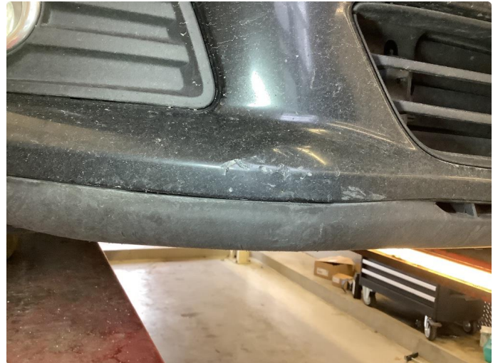
3.1 Generelt mye bruksslitasje
