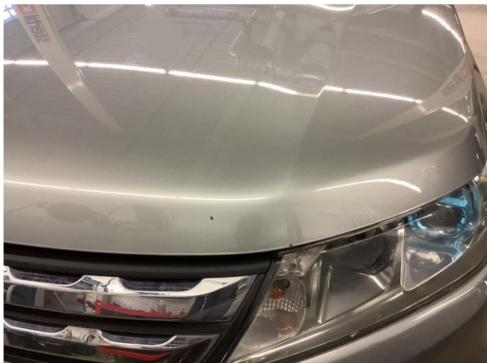
2.1 Noe steinsprut med rust
