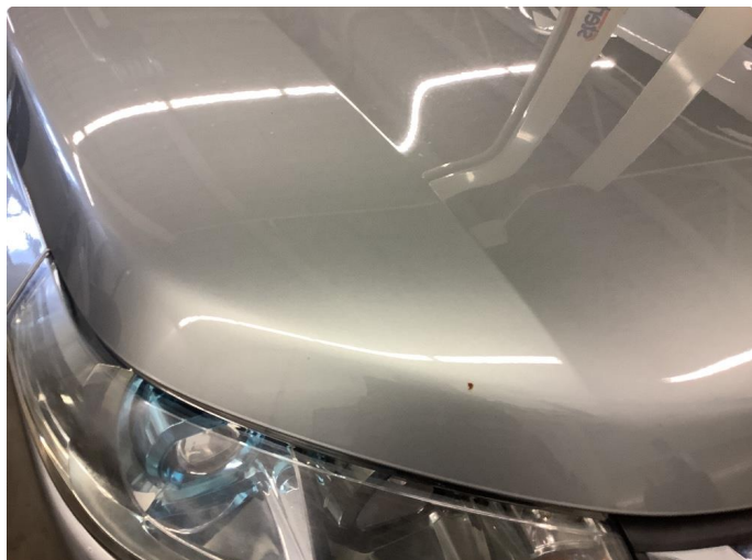
2.1 Noe steinsprut med rust
