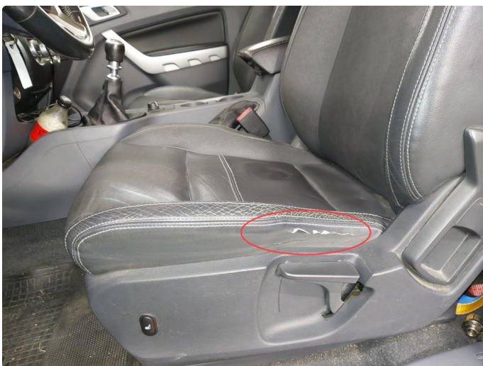
3.1 Skade på setetrekk
