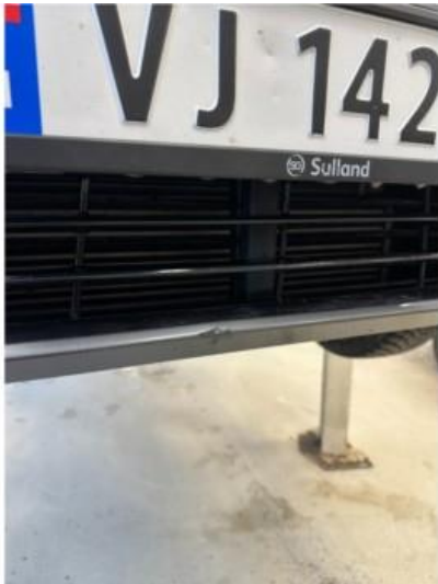
1.2 Liten støtskade i fanger foran. Normal slitasje
