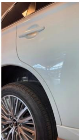
1.1 En steinsprut med rust på høyre baksjerm/hjulbue, flekket
