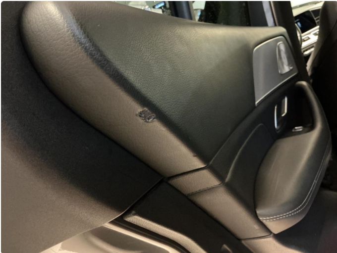
1.1 Skadet/merker etter utstyr
