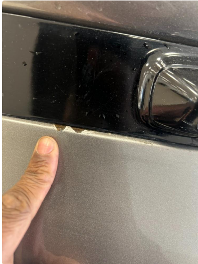
1.1 Noen rustflekker i bakluke. Pusses og lakkeres forenklet
