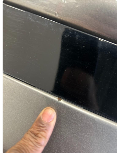
1.1 Noen rustflekker i bakluke. Pusses og lakkeres forenklet
