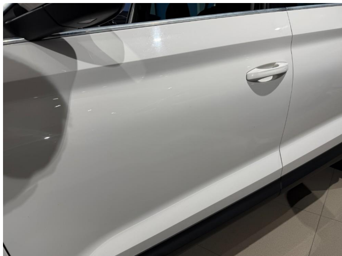
1.2 Korrodert steinsprang førerdør.
