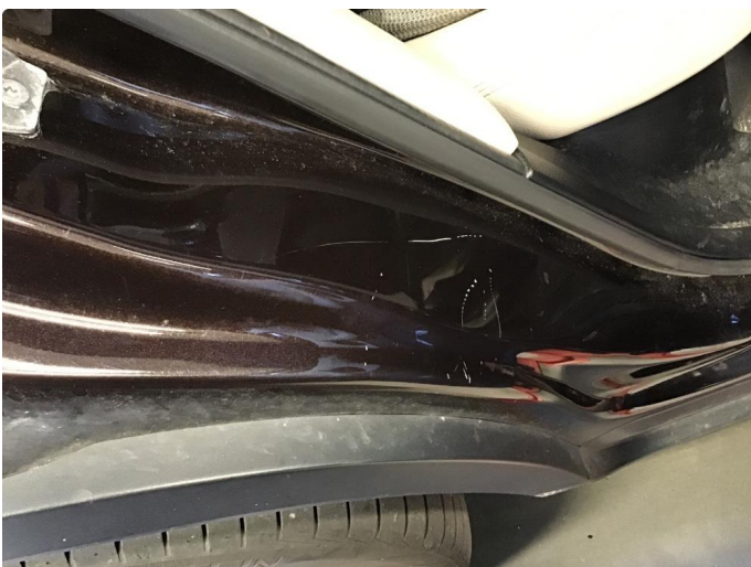
1.4 Slitasje i døråpninger
