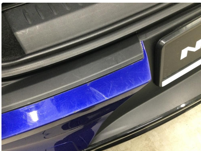
1.2 Ripe(r) ned til grunning
